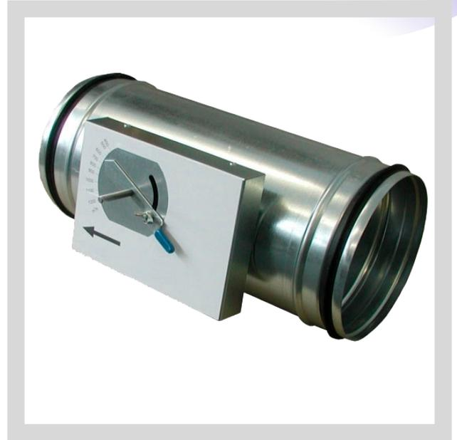
Самодействующие механические регуляторы расхода воздуха с постоянным потоком предназначены для систем подачи или отвода воздуха. Могут устанавливаться в горизонтальном или вертикальном положении с горизонтальной осью поворота заслонки регулятора. Аэродинамические силы действующие на лист регулятора выравниваются с помощью механизма управления настроенного на требуемый расход.
