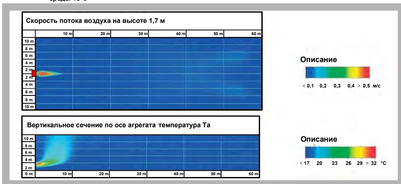
Рис. 13. Воздуонагреватель MONZUN 130. Макс. расход воздуха, положение жалюзи - 45°, температура окружающей среды 18°C
